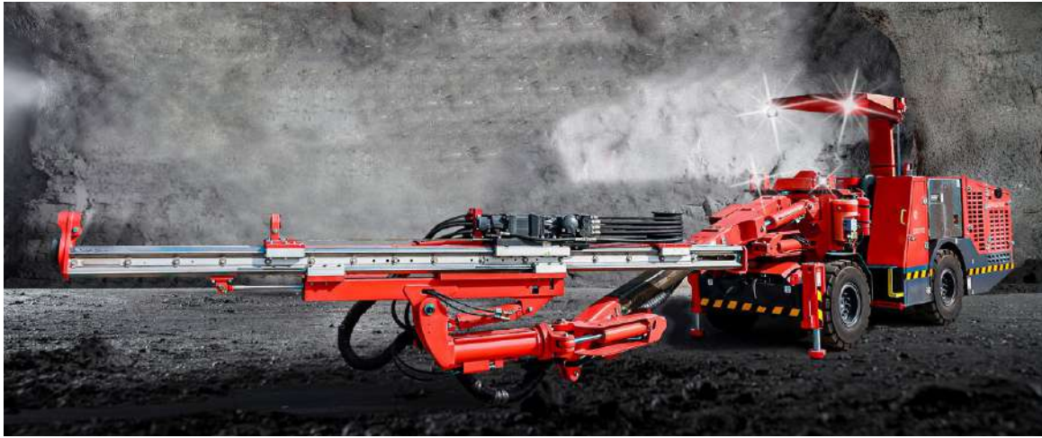
Figura 11. Equipos de perforación tipo jumbo.
