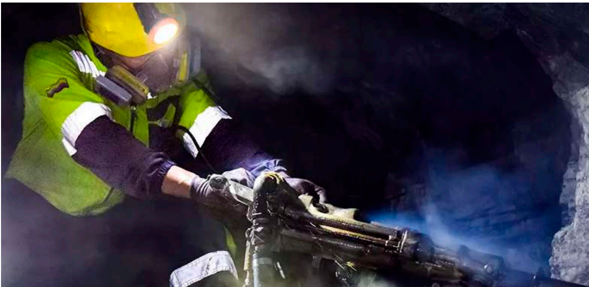
Figura 10. Trabajador minero con martillo neumático tipo jackleg
