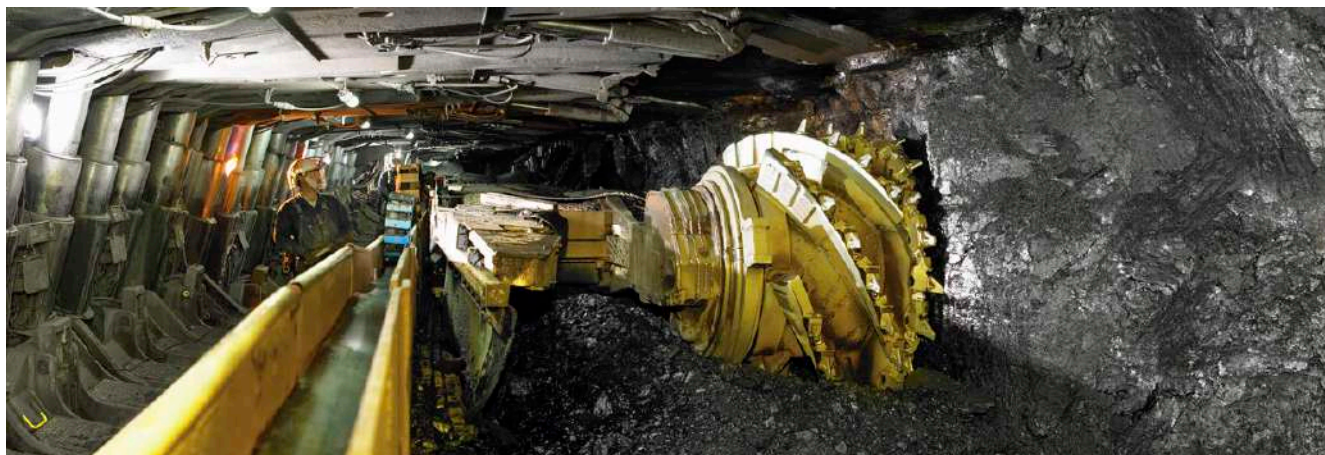
Figura 22 Frente de tajo largo. Fuente: Peabody Energy (2015).
