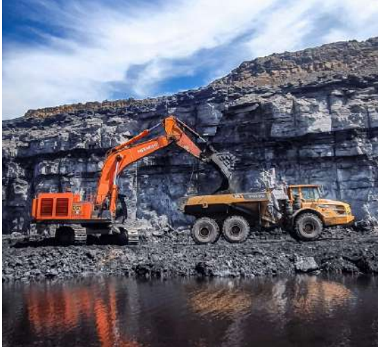
Figura 13. Equipos de minas a cielo abierto. a. Retroexcavadora cargando a un camión articulado; b. cargador frontal en frente de trabajo
