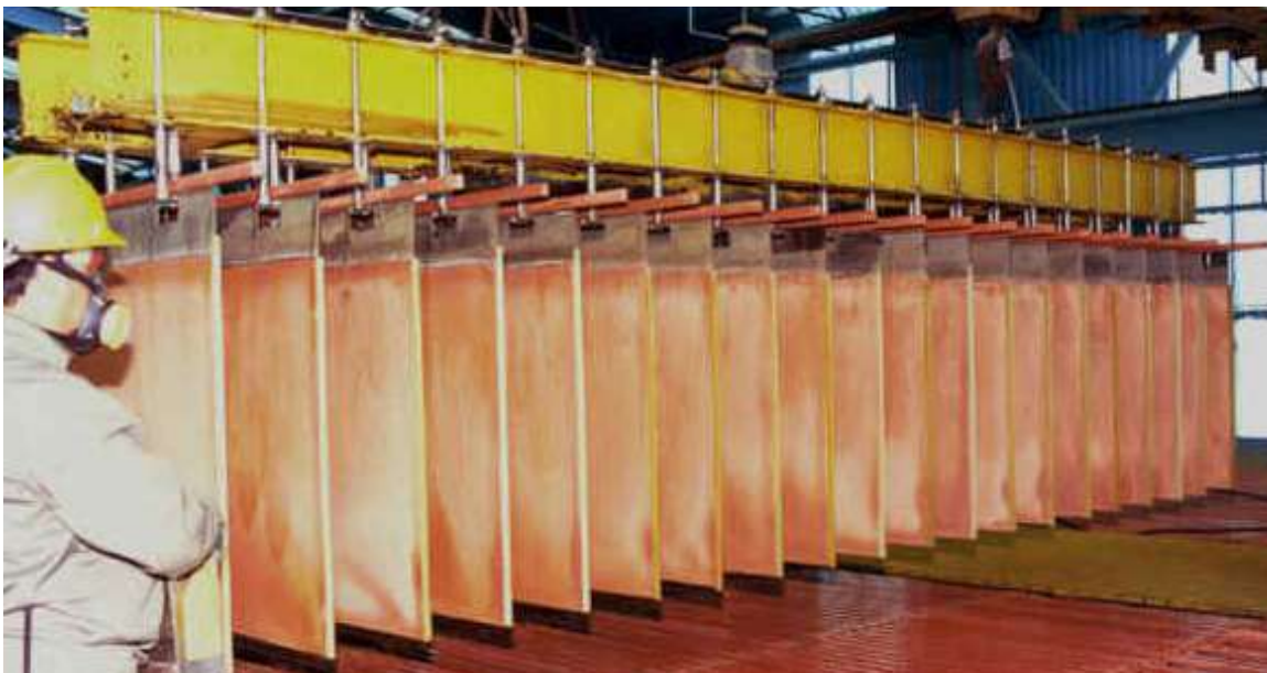
Figura 17. Proceso de electroobtención en el procesamiento de cobre Fuente: Pizarro (2015).
