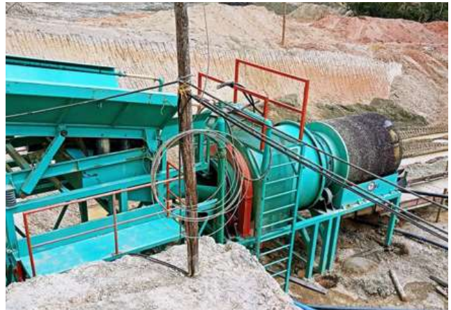
Figura 8. Sistema de criba vibratoria y trommel Fuente: Archivo del Grupo de investigación Observatorio ÍGNEA – Universidad Nacional de Colombia.
