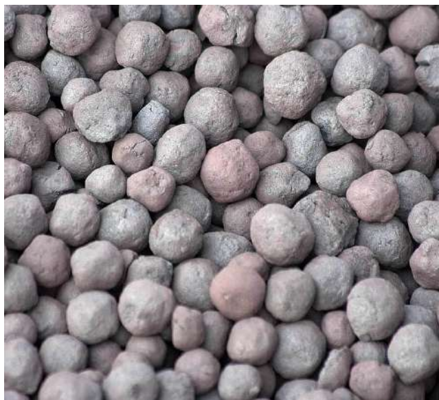
Figura 19. Pelets de mineral de hierro Fuente: Bukharov (2009).
