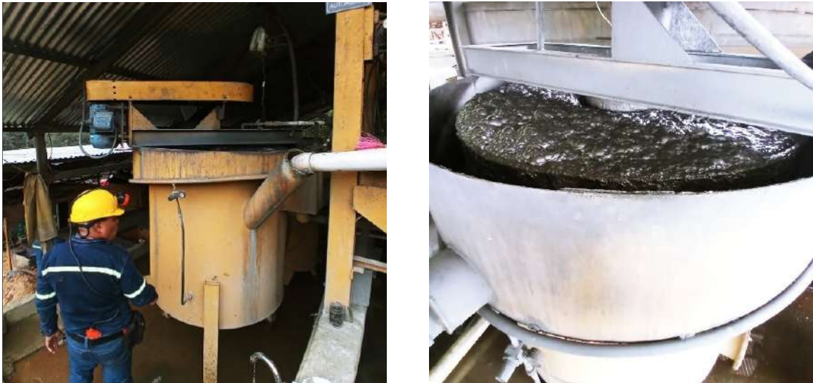
Figura 11. Celda de flotación en funcionamiento
