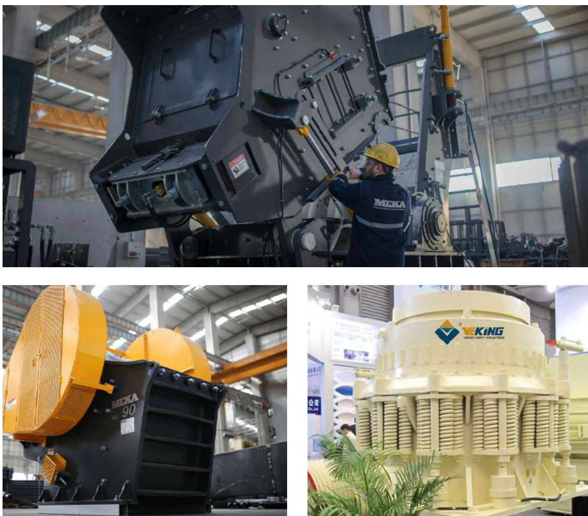
Figura 5. Maquinaria del proceso de trituración. a. trituradora de impacto, b. trituradora de quijadas y c. trituradora de cono
