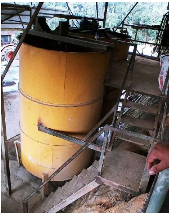
Figura 13. Tanques para lixiviación por agitación mecánica
