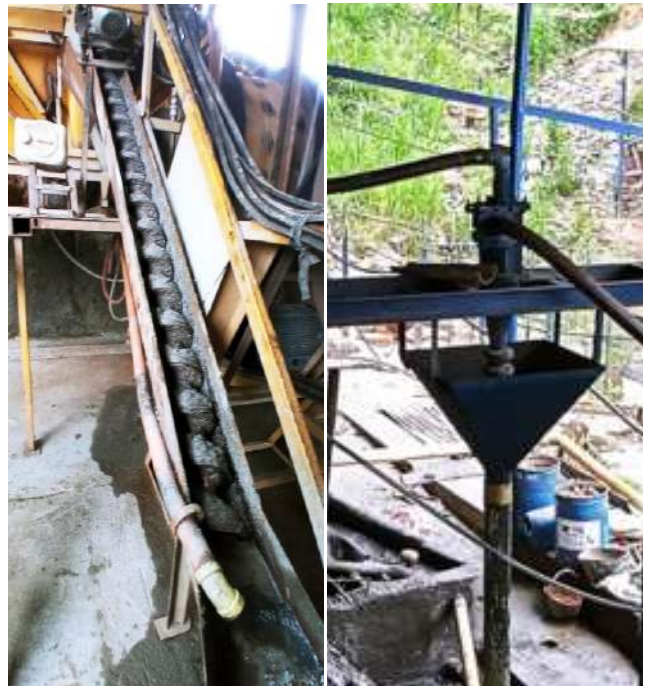
Figura 9. Equipos de clasificación en fluido. a. Un clasificador de espiral y b. un hidrociclón Fuente: © Archivo del Grupo de investigación Observatorio ÍGNEA – Universidad Nacional de Colombia.
